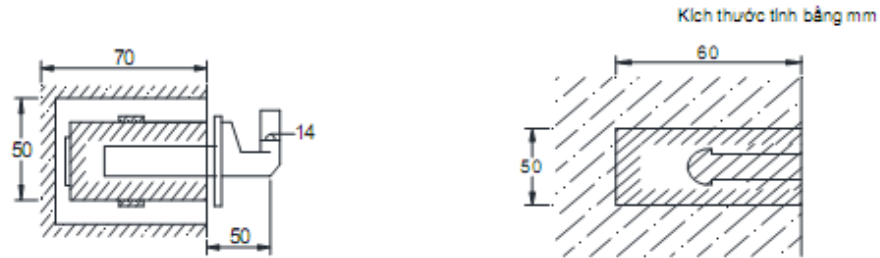
Hình B.1 - Móc đo độ lún có cấu tạo vững chắc
